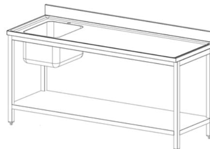
Avec dossieret 100x20mm et cuve soudé 400x400x200mm
